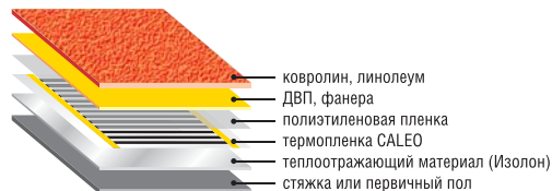
Рис. 3. Схема монтажа теплого пола CALEO под ковролин или линолеум
