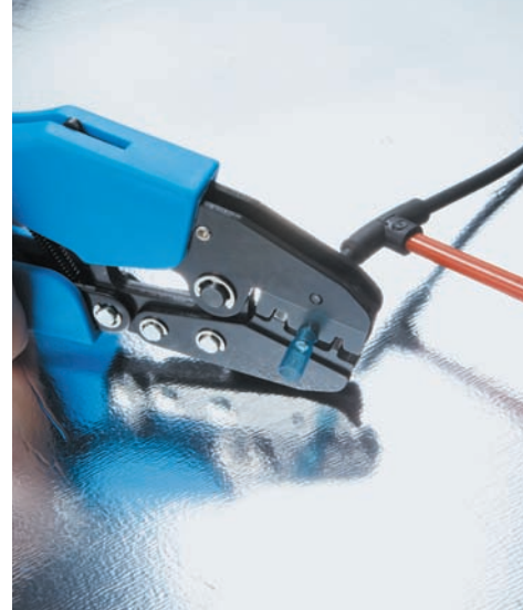
Рис. 7. Зажатие гильзы в термоусаживаемой трубке
