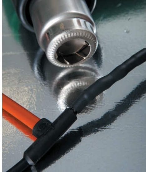
Рис. 14. Усадка термоусаживаемой трубки техническим феном
