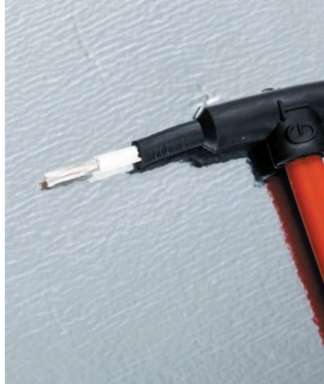
Рис. 6. Вид провода со снятыми слоями изоляции
