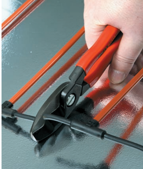
Рис. 8. Пример правильного разделения UNIMAT
