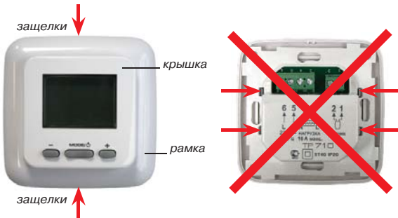
Рис. 11 Снятие крышки прибора
